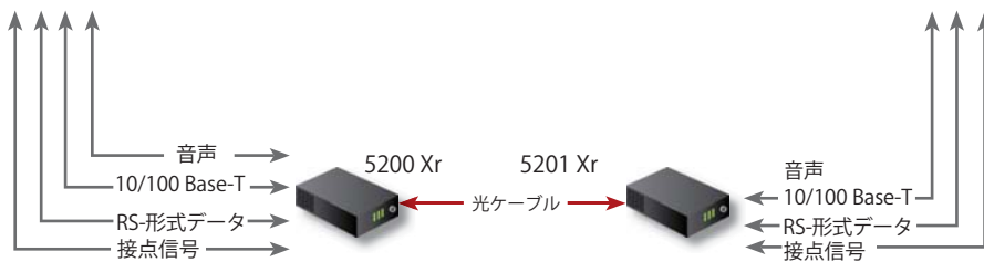
双方向音声, データ, イーサネット, 接点信号の1心光ケーブル伝送
