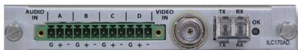
背面パネルの電気映像入力、アナログ映像または AES 音声入力 および SFP トランシーバスロット。
