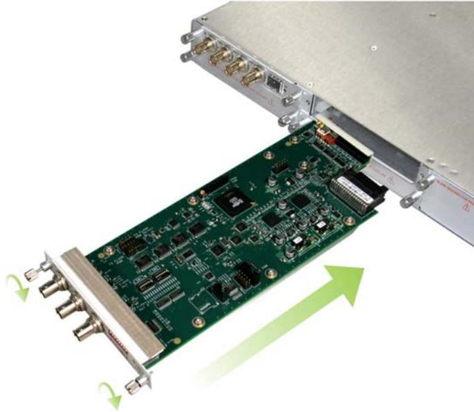
**Figure 17. DLT710 Module Installation**
